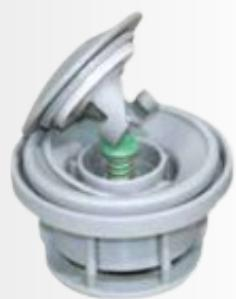
*Valve de gonflage pour flotteur Néoprène-Hypalon et PVC - Libération de la soupape par appuis verticale avec lock/delock. - Couleur : Noir/Grise - Diamètre du trou: 35 mm - Diamètre de la valve: 55 mm - Hauteur de la valve: 40 mm*
